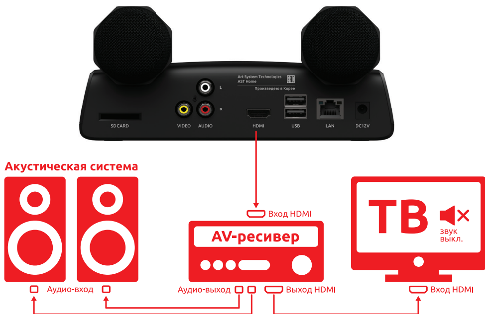
Рис. 2. Примерная схема подключения к ресиверу домашнего кинотеатра
