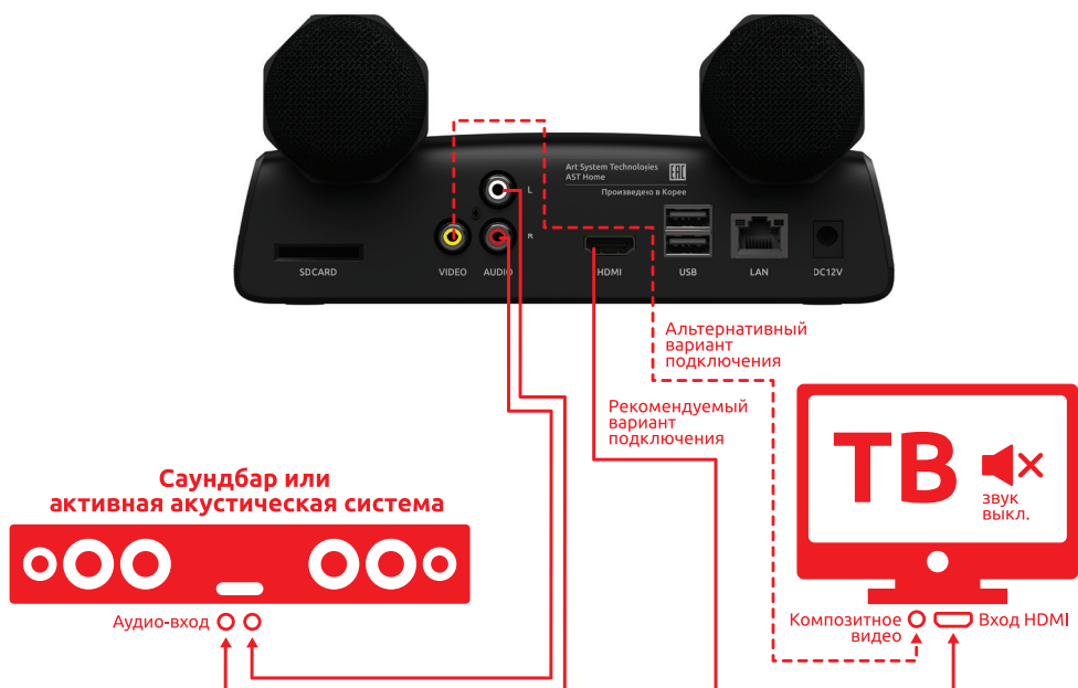
Рис. 4. Примерная схема подключения к активной акустической системе
