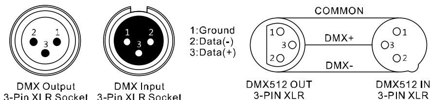
Для длинных DMX линий или при высоких помехах от электрической сети, например, на дискотеке, рекомендуется использовать DMX-терминатор. DMX-терминатор, это XLR-разъем, который имеет сопротивление 120 Ом между контактами 2 и 3, подключается в последний выходной разъем линии DMX.
