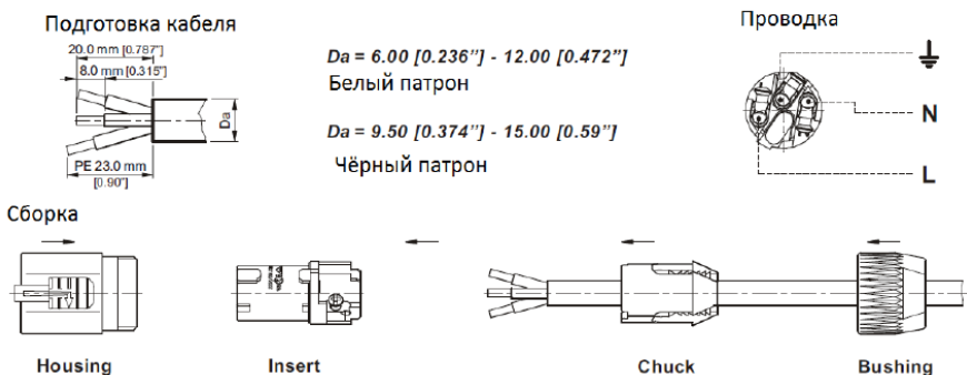
Рисунок 9 – Соединение разъёма входа питающего напряжения с кабелем
