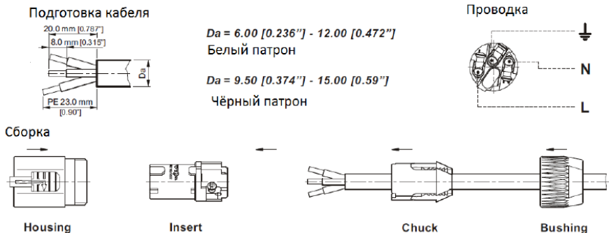
Рисунок 9 – Соединение разъёма входа питающего напряжения с кабелем
