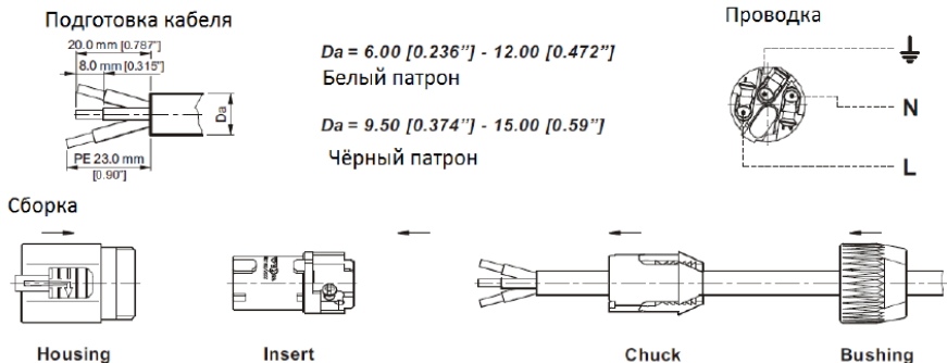
Рисунок 10 – Соединение разъёма входа питающего напряжения с кабелем
