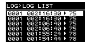
Поворот основного регулятора (для выбора события) и нажатие регулятора (для фактического определения события) приводят к отображению подробного представления.
