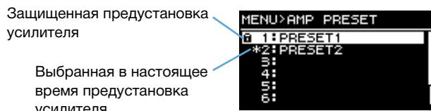
Выберите номер предустановки усилителя, повернув основной регулятор и нажав его. Отображается экран выбора последовательности действий.
