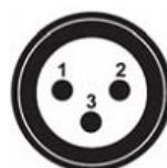
DMX – вход панельный разъем XLR «папа»
