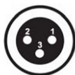
DMX – выход панельный разъем XLR «мама»
